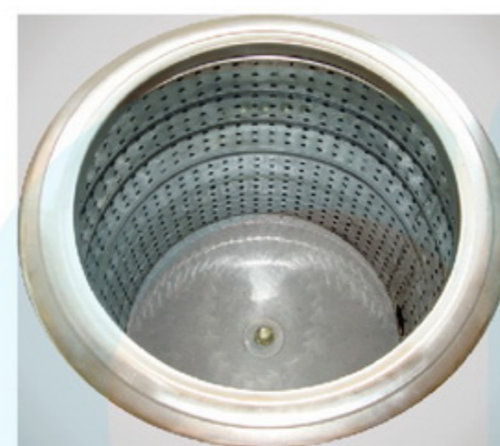
Drum terbuat dari stainless steel
