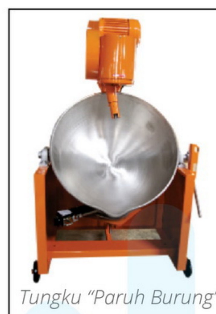
Stirrer : Dengan Teflon Blade Tahan Panas hingga 300°C
